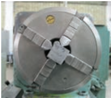
شکل ۲-۷ بستن قطعه کار با مقطع چهارگوش
