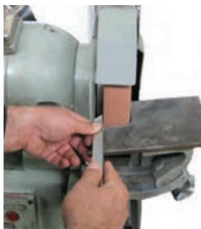
شکل ۱۱-۴ تیز کردن زاویه براده
