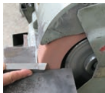
شکل ۱۰-۴ تیز کردن زاویه آزاد بغل
