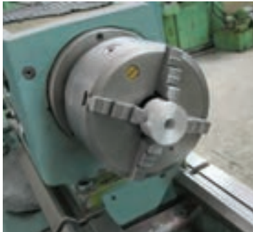
شکل ۲-۸ بستن قطعه کار با مقطع گرد
