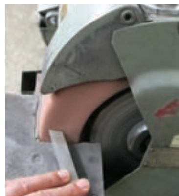
شکل ۹-۴ تیز کردن زاویه آزاد پیشانی
