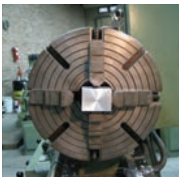
شکل ۲-۱۰ بستن قطعه کار با مقطع مستطیل شکل
